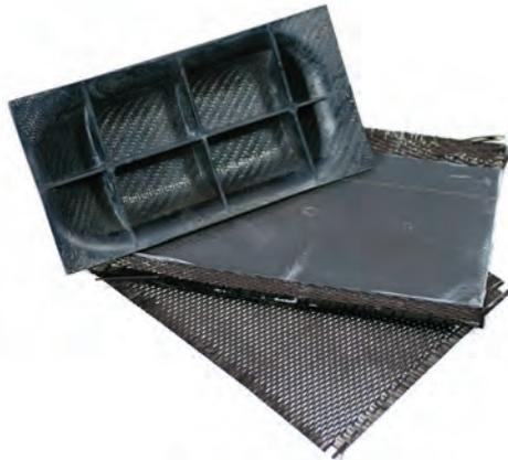
**Abbildung 4:** Wanneprobekörper, hergestellt im IMI-Verfahren.
