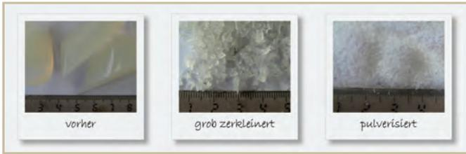
Abb. 3: 10 g Polyurethan wurden in ca. 60 sec in der ZM 200 auf <math>< 400 \mu\text{m}</math> vermahlen, nachdem die Vorzerkleinerung in der Schneidmühle SM 300 vorgenommen worden war.
