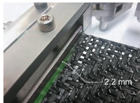
**Abbildung 3:** Unaufgeschmolzener Bereich von 2,2 mm Breite nahe der Einspannung bei einem Scherrahmen, hier gezeigt für ein PP-GF Organoblech nach Prüfung bei 220 °C.
