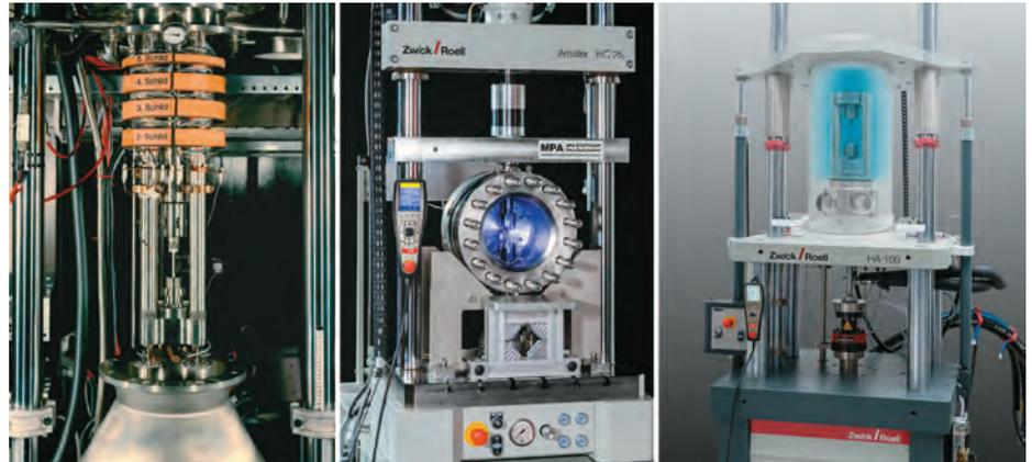
**Abbildung 13:** Prüfsysteme zur Untersuchung des Werkstoff- und Bauteilverhaltens unter Wasserstoff.
