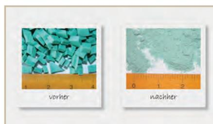
Abb. 2: 2 g Silikon vor und nach der Vermahlung in der CryoMill, überwiegend < 250 µm nach 10 min
