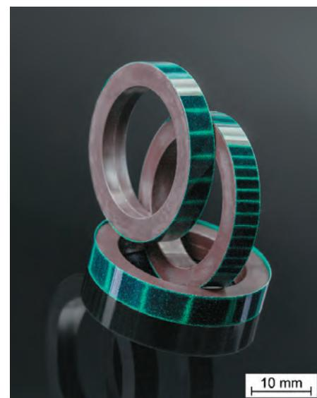
**Abbildung 1:** Polorientiert spritzgegossene Magnetringe mit unterschiedlichen Polteilungen für die Anwendung als Signalgeber in der Sensorik.
