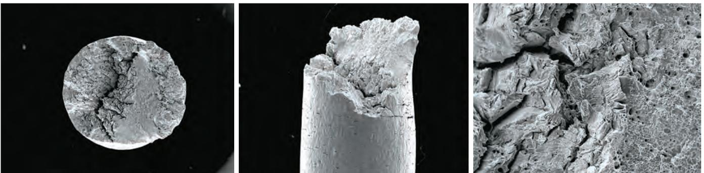
Abbildung 12: Fraktografie einer Zugprobe aus dem Werkstoff 1.4306 (mod. Variante) in Wasserstoffumgebung.
