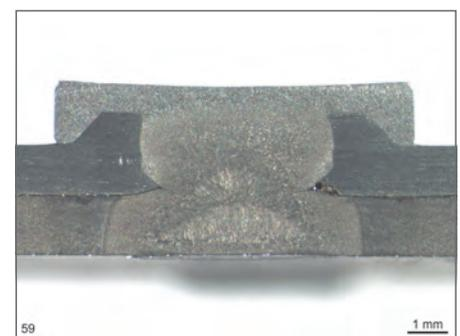
**Abbildung 6:** Makroschliff einer einstufigen WES-Verbindung (Deckblech: EN-AW 6016 T4, Basisblech: 22MnB5+AS150) mit 35 mm Überlappungslänge.
