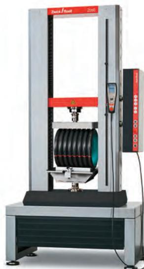
Abbildung 1: Ermittlung der Ringsteifigkeit von Kunststoffrohren
