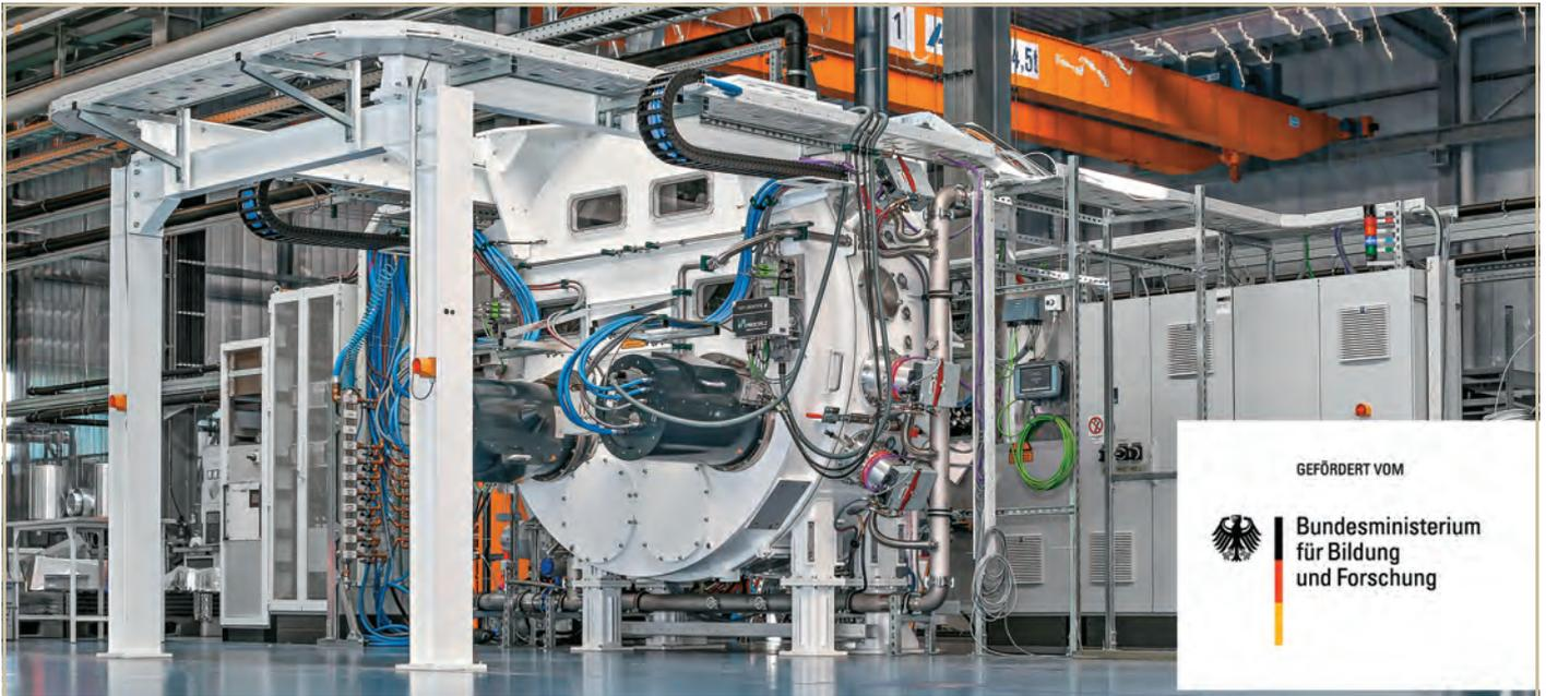
© VON ARDENNE Corporate Archive: FOSA LabX 330 Glass: Beschichtungsanlage für flexibles Glas von der Rolle
