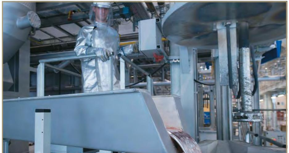
Überführung der Schmelze in den Transport- bzw. Reinigungstiegel
